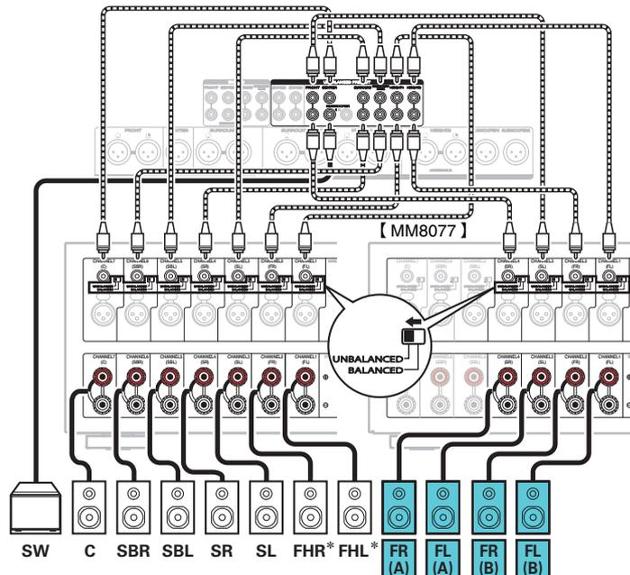
\* Los altavoces de altura, altavoces de techo y altavoces Dolby Atmos Enabled se pueden conectar a los terminales del altavoz HEIGHT1. Establezca el altavoz que se vaya a conectar mediante la opción "Altura" - "Distribución" del menú. (☞ p. 224)
