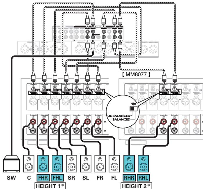
\* Puede cambiar la combinación de los canales HEIGHT1 y HEIGHT2 en la configuración. (ver p. 66)
