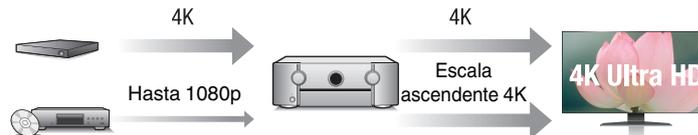
Esta unidad está equipada con una función de escalado de vídeo de 4K que permite la salida de vídeo analógico o SD (Standard Definition) a través de HDMI a una resolución de 4K (3.840 × 2.160 píxeles). Esta función habilita la conexión del dispositivo al TV utilizando un solo cable HDMI y produce imágenes en alta definición para cualquier fuente de vídeo.
